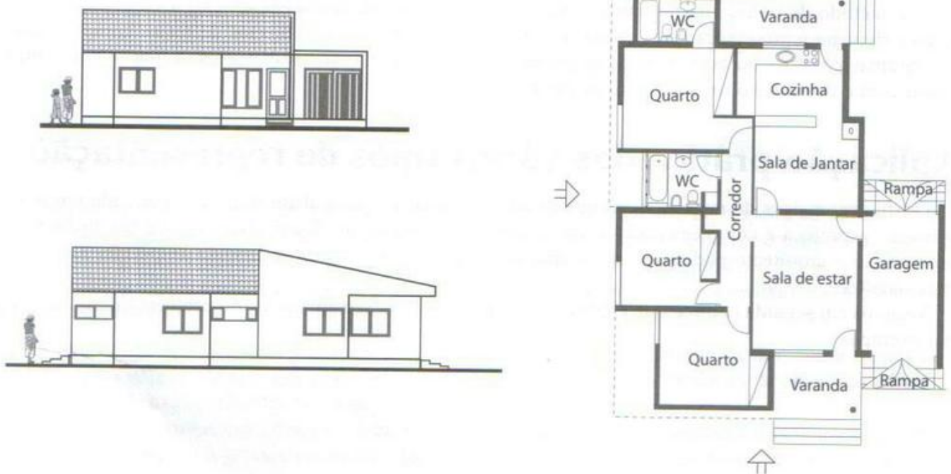
Representação de alçados de uma casa e a sua respectiva planta.
