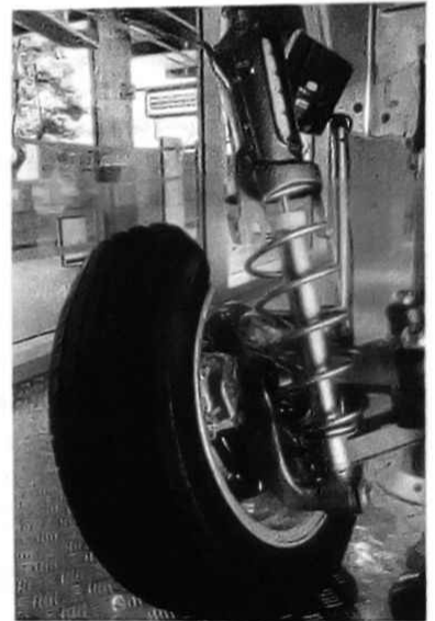
Fig. 6.23 Os amortecedores do sistema de suspensão de um avião reduzem a amplitude de oscilação quando este entra em oscilação devido ao mau estado da pista.
