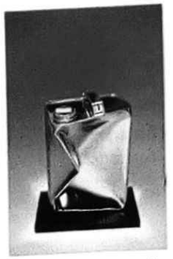
Fig. 4.20 Extraíndo o ar da lata, esta deforma-se por todos os lados devido às forças de pressão atmosférica que se exercem em todas as direcções.
