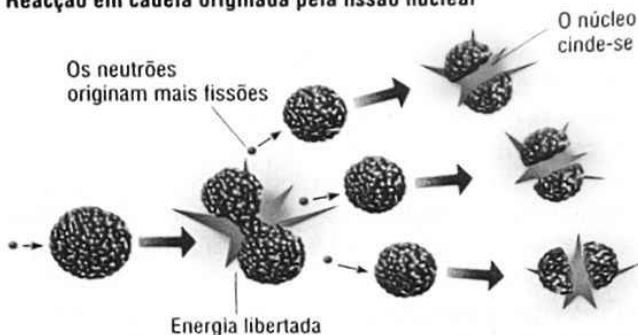
Fig. 3.26 Reacção nuclear em cadeia do urânio-235. Em poucos segundos, o número de fissões é muito grande e a reacção torna-se incontrolável, libertando-se uma elevada quantidade de energia.
