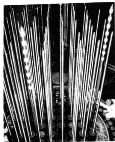
Fig. 3.18 Barras de combustível nuclear no interior de um reactor nuclear.
