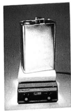
Fig. 4.20 Extraíndo o ar da lata, esta deforma-se por todos os lados devido às forças de pressão atmosférica que se exercem em todas as direcções.
