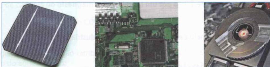
Fig. 22 O silício amorfo e o cristalino são usados como conversores de energia solar em energia eléctrica e no fabrico de chips electrónicos.
