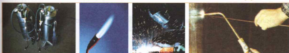
Fig. 21 O acetileno guardado em botijas de aço é usado nos maçaricos oxi-acetilênicos utensílios de corte, fusão e soldadura de metais.
