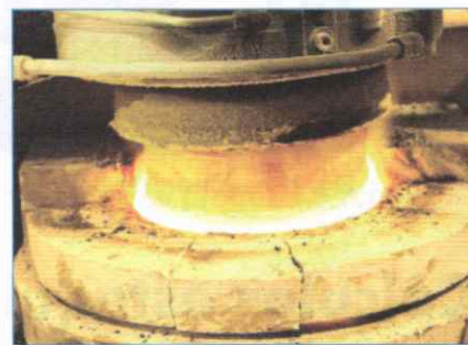
Fig. 25 Vidro fundido durante o processo da sua fabricação.
