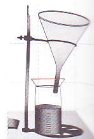
Fig. 1.1 Processo de filtração.
