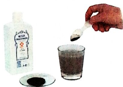
Fig. 39 – O dióxido de manganês, adicionado à água-oxigenada, fez com que a decomposição da água-oxigenada fosse mais rápida.
