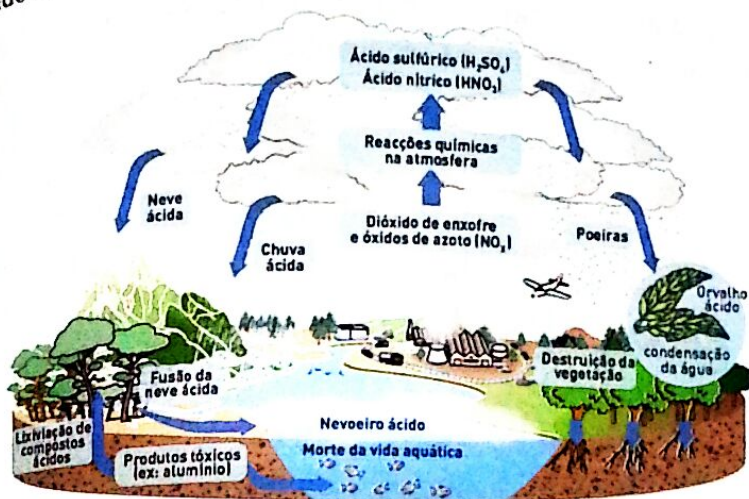
Fig. 4 – Esquema explicativo da formação de chuvas ácidas.
