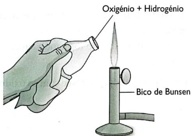
Fig. 18 Prova do gás fulminante.
